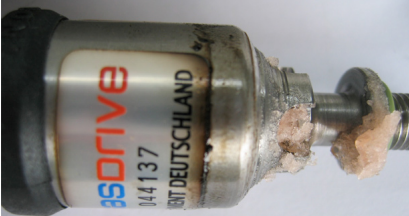
Abbildung 1: Additivrückstände im Filtergehäuse und am Gasfilter
