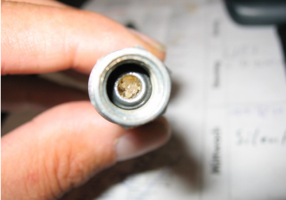
Abbildung 4: Durch Fremdadditiv zugesetzter Gasschlauch
