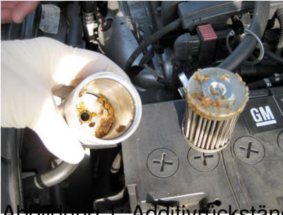
Abbildung 1: Additivrückstände im Filtergehäuse und am Gasfilter
