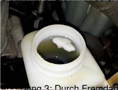
Abbildung 3: Durch Fremdadditiv aufgelöste Bestandteile des Vorratsbehälters
