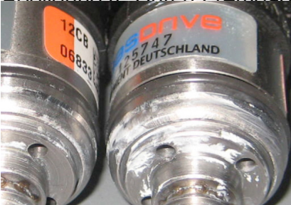
Abbildung 5: Durch Fremdadditiv zugesetzter Gasinjektor
